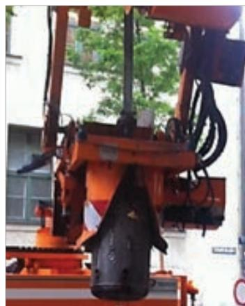
Automatische Entleerung der Eimer mit einer Aushebeanlage durch eine Fachfirma (Beispiel Stadt München).
